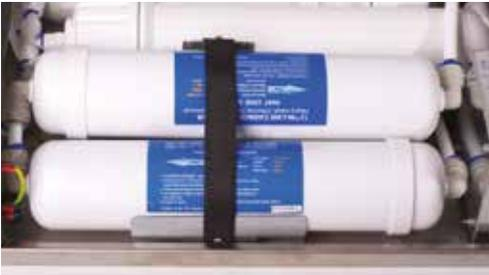
Wenn Kabelbinder: Der Verschluss kann leicht durch Wegdrücken der Arretierung geöffnet werden, ansonsten Halteband lösen
