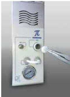
Bitte kontrollieren Sie bei jedem Filterwechsel auch das Sieb im EingangsfILTER (FEED). Sollte sich Schmutz im Sieb angesammelt haben, lässt es sich von außen ganz leicht mit einer Zange herausziehen und ausspülen.
