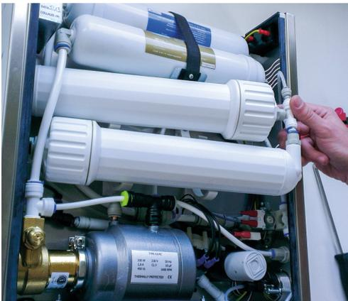
10. Heben Sie nun das alte Membranpaar aus dem Gehäuse und platzieren Sie ein Tuch an der Unterseite des Gehäuses, um eventuell heraustropfendes Wasser abzufangen.
