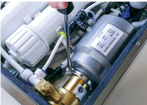
8. Lockern Sie die Verschraubung an der linken Seite der Pumpe mit einem Kreuz- oder Schlitzschraubenzieher.
