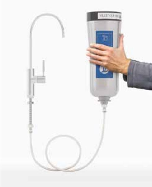
**WICHTIG:** Nach dem Filterwechsel kann etwas Luft in die Schläuche gelangt sein. Daher Anlage einschalten und laufen lassen. Während dieses Spülvorganges drehen Sie den PI®-Cell Vitalizer Special „up side down“, damit allfällige Luft, die sich noch im PI®-Cell Vitalizer Special befinden kann, herauskommt. Die Luft ist erst dann komplett entwichen, wenn das Wasser sprudelfrei fließt.
