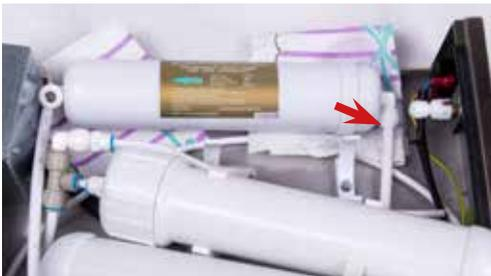
Setzen Sie den neuen Filter ein, in dem Sie als Erstes den Schlauch auf der Manometer-Seite verbinden. Sie können hier auch gleich den Sicherungsring anbringen.
