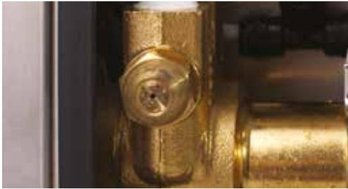
Nach dem Filterwechsel bitte Arbeitsdruck der Pumpe überprüfen und Nachjustierung durchführen. Der Arbeitsdruck der Pumpe kann mittels Einstellschraube verändert werden. (Im Uhrzeigersinn wird der Druck erhöht.)
