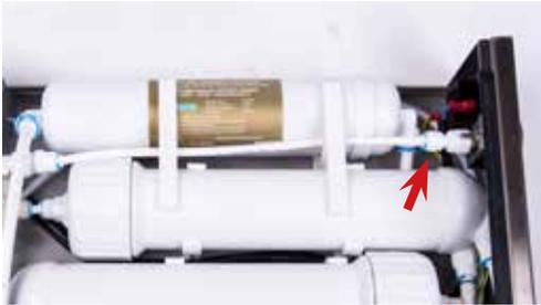
Führen Sie den Schlauch vom Manometer durch die Halterungsklemmen und verbinden Sie diesen mit dem Manometer. Bringen Sie den Sicherungsring an.
