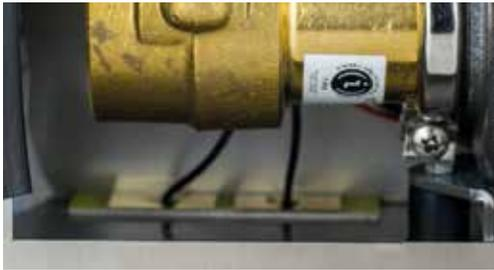
Feuchtigkeitssensor in der Umkehrosmose („LEAKING“ Anzeige am Display): Beim Filterwechsel kann Feuchtigkeit entstehen, die dazu führt, dass der Sensor das Gerät abstellt. Bitte diesen trocknen und Maschine wieder in Betrieb nehmen.
