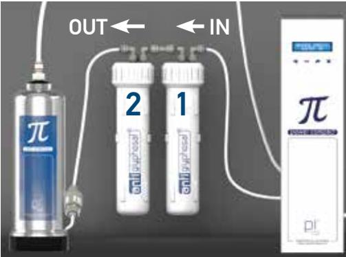
Lösen Sie den Schlauch aus der mittig aufgesetzten Steckverbindung des Filters 2 und führen diesen wieder in die obere Öffnung des PI®-Cell Vitalizers ein. Stecken Sie stattdessen den Schlauch von der unteren Öffnung des PI®-Cell Vitalizers in die mittig aufgesetzte Steckverbindung des Filters 2. (Die Verbindung zwischen der Umkehrosmose und dem Filter 1 bleibt wie gehabt.)
