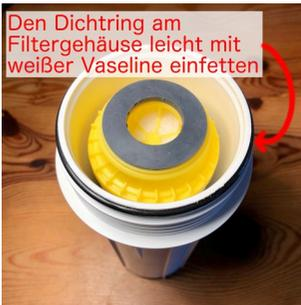
Die Kartusche muss so wie abgebildet mit dem Dichtring der Kartusche nach oben eingesetzt werden.
