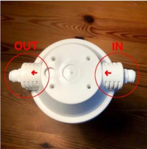
Auf dem Deckel des Filtergehäuses ist der Eingang mit **IN** (hier wird das Leitungswasser angeschlossen) und der Ausgang mit **OUT** (hier wird die Osmoseanlage angeschlossen) gekennzeichnet. Ein aufgedruckter Pfeil zeigt die Fließrichtung vom Wasser.
