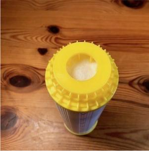
Dies ist die andere Seite ohne Dichtring. Ganz unten im Filtergehäuse ist ein kleiner Rohrstutzen der in die runde Öffnung des gelben Kunststoffes ragt.
