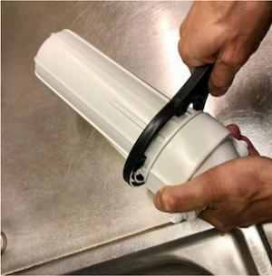
Mit Hilfe des Filtergehäuse-schlüssels und etwas Kraft kann man das Filtergehäuse öffnen und die verbrauchte Kartusche entnehmen. Beim einsetzen der neuen Filterkartusche ist unbedingt dar-
