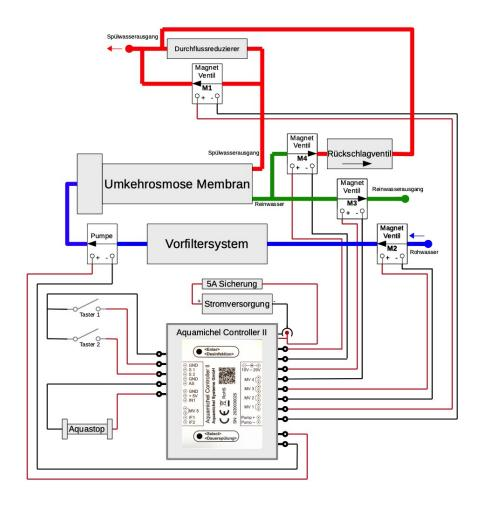
**Hinweis:** Bei Filtersystemen, die ohne Vordruck arbeiten, z.B. Filter mit selbstsaugender Pumpe, die direkt aus einem drucklosen Wassertank saugt, ist es besser die Pumpe vor das Vorfiltersystem zu schalten und nicht wie oben abgebildet nach dem Vorfiltersystem. Selbstsaugende Pumpen kommen oft mit der Luft, die in den Vorfiltern sein kann, nicht klar und bauen dann zu wenig Druck auf.
